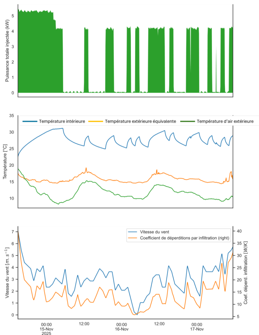
Figure 33 : Evolution des conditions pendant le test SEREINE – Pont-sur-Seule après travaux. Haut : puissance électrique de chauffe injectée ; milieu : températures ; bas : vitesse de vent et coefficient de déperdition par infiltration.
