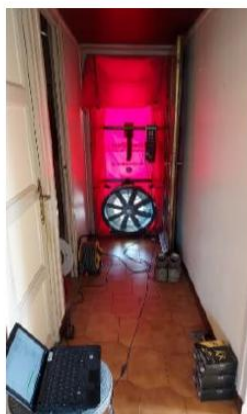
Figure 74 : Mise en place de la fausse porte lors des essais d'infiltrométrie (chantier Chambéry)
