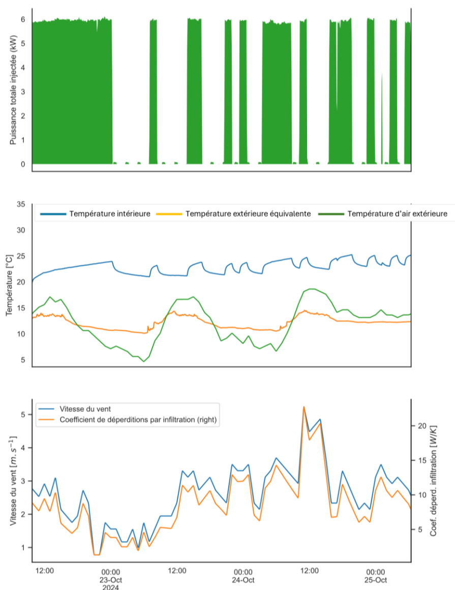
Figure 49 : Evolution des conditions pendant le premier test SEREINE - Agneaux. Haut : puissance électrique de chauffe injectée ; milieu : températures intérieure et extérieur équivalentes ; bas : vitesse de vent et coefficient de déperdition par infiltration.
