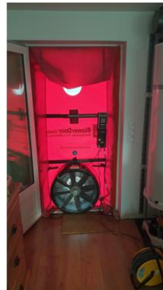
Figure 74 : Mise en place de la fausse porte lors des essais d'infiltrométrie (chantier Chambéry)
