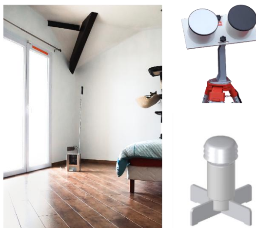
Figure 6 : A gauche un module de chauffage, à droite des capteurs extérieurs d'ensoleillement et de température
